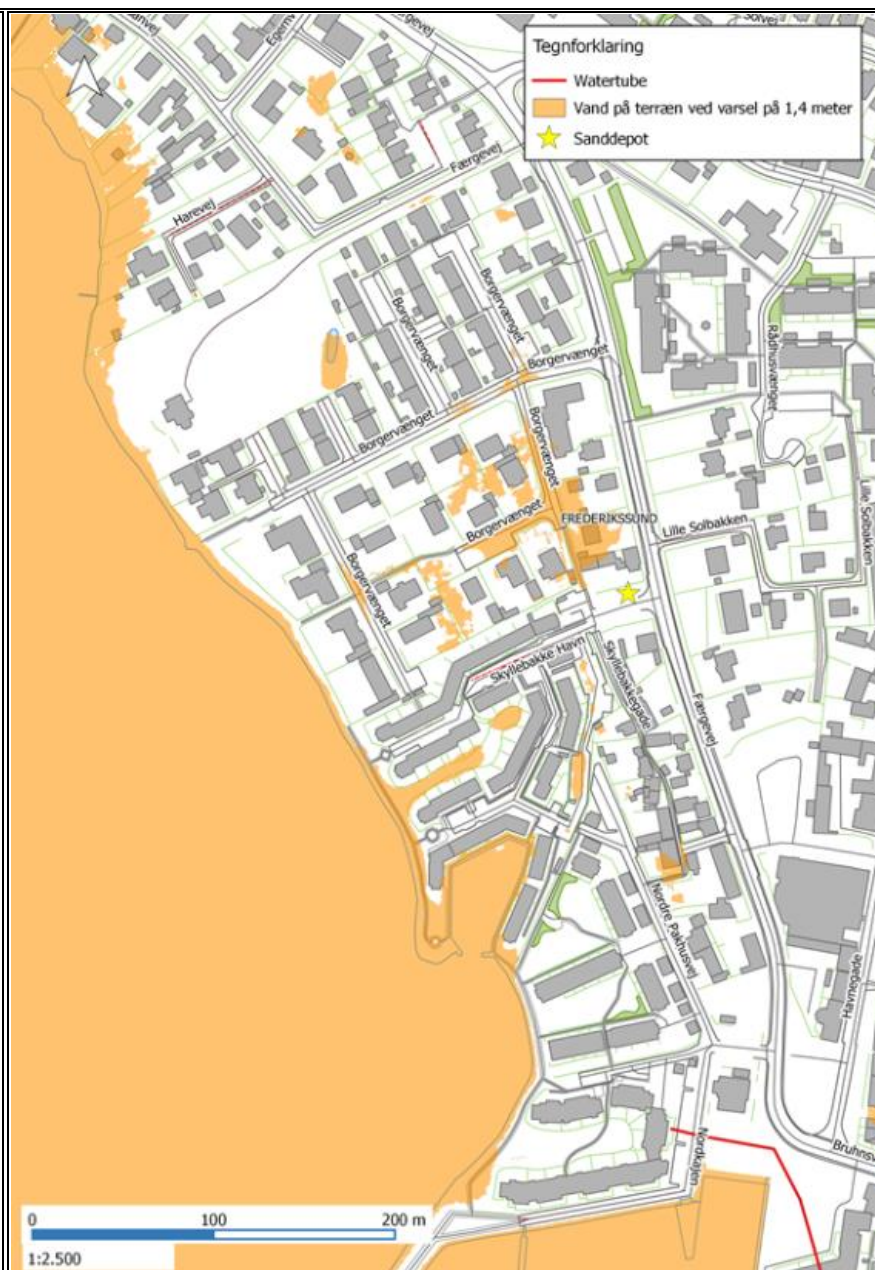
Kort over vand og oversvømmelser ved Skjellebakke Havn ved 140 cm vandstand. Grafik: Frederikssund Kommune.
