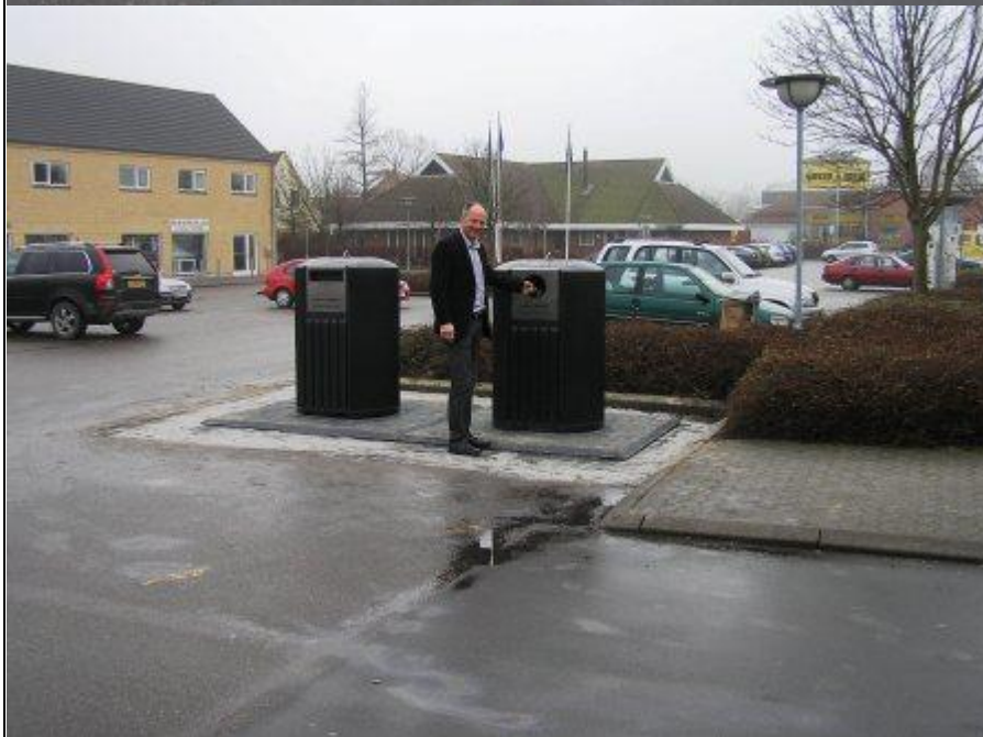
Sådan bruges de ny containere i Skibby bymidte – ligesom andre glas-og papircontainere. Blot forsvinder affaldet ned i en 'pose' et hul i jorden. Søren Jensen fra leverandøren, JOCA A/S, demonstrerer her glasbeholderen.
