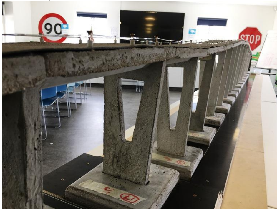
Brofundament, bropiller og brodæk er støbt i beton og samlet til en modelbro.
